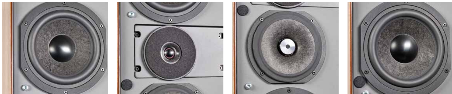
Von links nach rechts: Tiefmitteltöner – nicht zu sehen ist das induktive Dämpfungssystem, mit dem sich das Bassverhalten dem Raum und dem Hörgeschmack anpassen lässt. Daneben der Hochtöner, der nicht etwa eine Kalotte mit Hornvorsatz, sondern ein 40-mm-Konus ist. Eine Zelle weiter der zentrierspinnenlose Mitteltöner und schließlich ... erwischt: Wir haben einfach kopiert, wie Manfred Diestertich an der Cardeas auch, nur dort eben vertikal.
