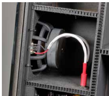
Jede Kammer des Schnittmusters ist ein kleines Fenster in Manfred Diestertichs wundersame Welt des Lautsprecherbaus. Von links nach rechts: zwei Signalleitungen zum Motorsystem eines der Tiefmitteltöner – eine für die Antriebs- und eine für die Dämpfungsspule; der Korb des zentrierspinnenlosen Mitteltöners in Flachbauweise; Teile der „schwimmenden“ Frequenzweiche mit Filterelementen beiderseits des Treibers; einer der beiden 28-cm-Tieftöner.
