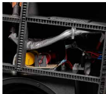
Jede Kammer des Schnittmusters ist ein kleines Fenster in Manfred Diestertichs wundersame Welt des Lautsprecherbaus. Von links nach rechts: zwei Signalleitungen zum Motorsystem eines der Tiefmitteltöner – eine für die Antriebs- und eine für die Dämpfungsspule; der Korb des zentrierspinnenlosen Mitteltöners in Flachbauweise; Teile der „schwimmenden“ Frequenzweiche mit Filterelementen beiderseits des Treibers; einer der beiden 28-cm-Tieftöner.
