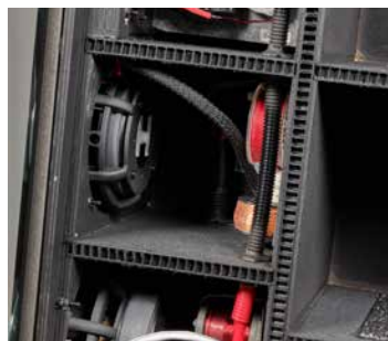
Jede Kammer des Schnittmusters ist ein kleines Fenster in Manfred Diestertichs wundersame Welt des Lautsprecherbaus. Von links nach rechts: zwei Signalleitungen zum Motorsystem eines der Tiefmitteltöner – eine für die Antriebs- und eine für die Dämpfungsspule; der Korb des zentrierspinnenlosen Mitteltöners in Flachbauweise; Teile der „schwimmenden“ Frequenzweiche mit Filterelementen beiderseits des Treibers; einer der beiden 28-cm-Tieftöner.
