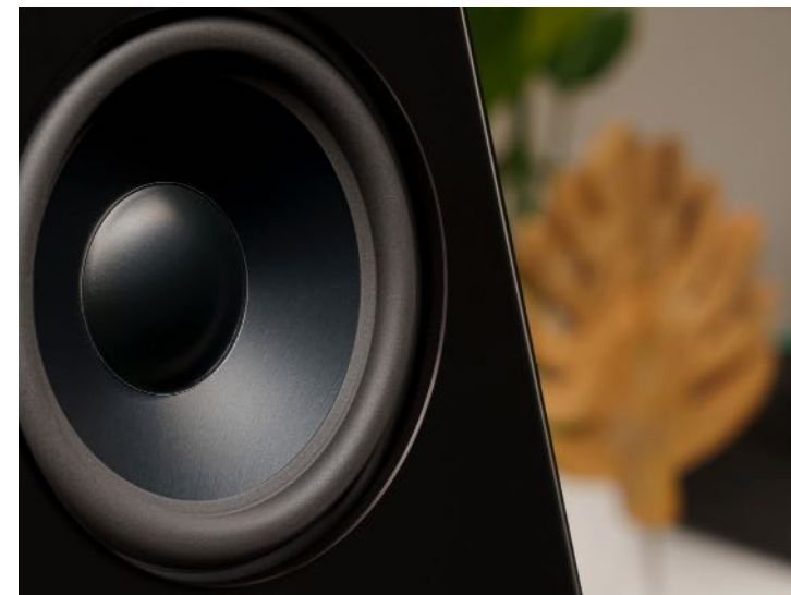
Der untere der beiden Bass-Woofers. Im Team mit seinem oben auf der Front thronenden Kollegen bietet er eine hohe resultierende Membranfläche. Die Tieftonfähigkeit wird auch durch die Langhub-Ausführung, das üppige Gehäusevolumen und die Bassreflex-Abstimmung gesteigert.
