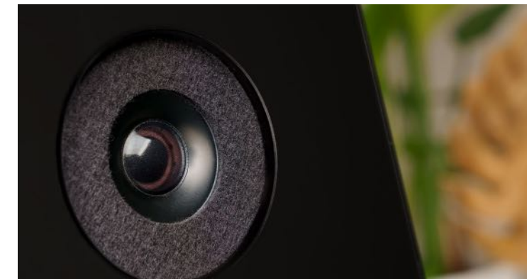
Der Hochtöner erscheint wie ein Kalotten-Tweeter, ist in Wirklichkeit aber ein Konus-Lautsprecher mit großer Staubschutzkappe.
