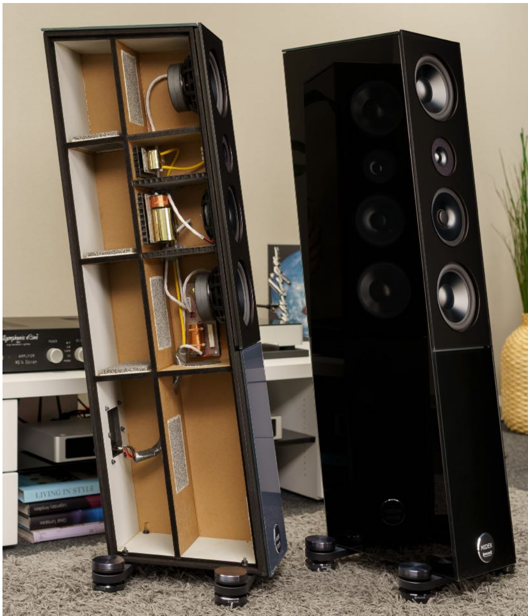
Das innovative Innenleben besteht aus einer neunteiligen Kammer-Konstruktion, die teils durch absorbierende Honeycomb-Wabensandwiches seismisch stillgelegt ist, teils über durchlässige Keramikscham-Platten eine Schall-Diffusion erfährt.
