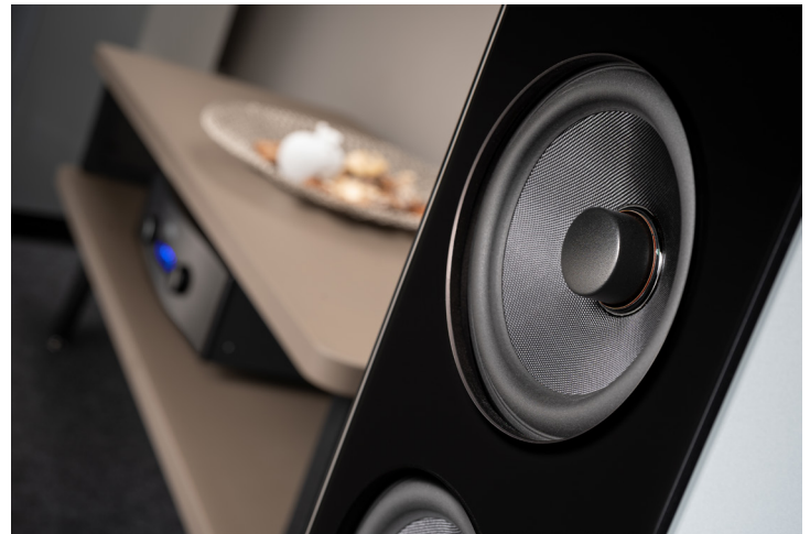
Der Mitteltieftöner leistet die meiste Arbeit, deshalb besitzt er zur Wärmeableitung einen Phase Plug. Für den sicheren Sitz des Speakers und zur Vibrationsvermeidung werden seine Befestigungsschrauben im Gehäuse von Neopren-Dübeln aufgenommen.
