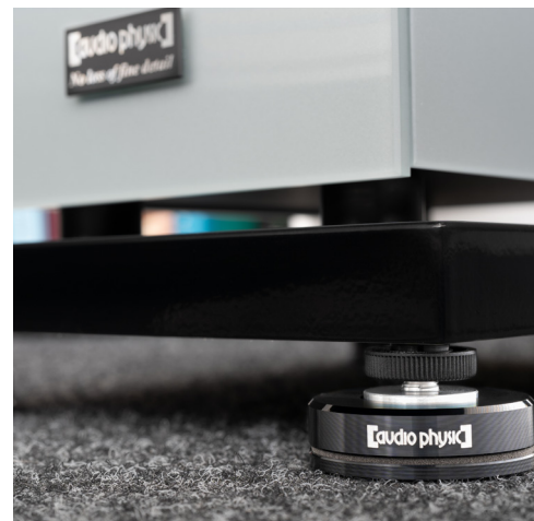
Zwischen Korpus und Sockel sitzen Abstandhalter. Sie lassen das Gehäuse der Classic 15 scheinbar schweben. Akustisch ist die Distanz nötig, damit die Luft durch den Bassreflex-Schlitz auf der Korpusunterseite strömen kann. Unter den Sockel sind hier statt der Standard-Spikes die optionalen VCF II M8 Magnetic-Standfüße geschraubt.
