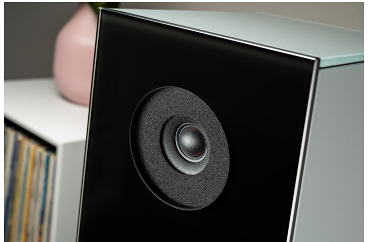
Der Hochtöner ist als Kalotte aus Kunstseide realisiert. Die ihn umgebende hornartige Mulde dient der Schallführung, der einfasende Filzring verhindert eine mechanische Schwingungsanregung der vorgesetzten schwarzen Glasplatte.
