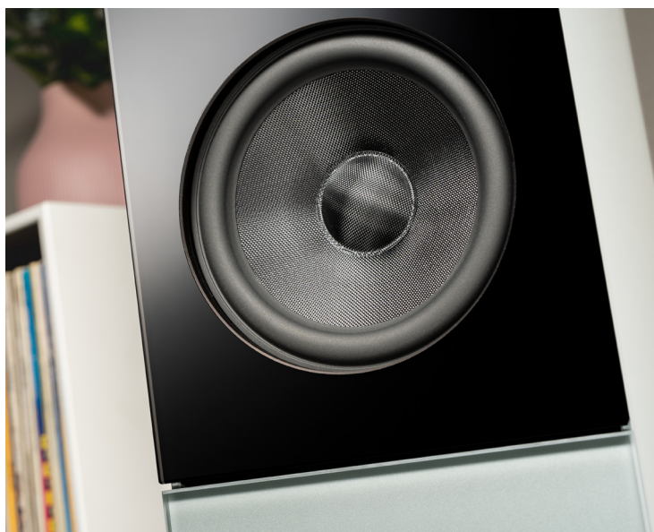
Der Tieftöner ist wie der Mitteltieftöner mit einer Membran aus verwobener Glasfaser ausgerüstet. Die fühlbare Struktur des Gewebes bewirkt eine große Stabilität und Steifigkeit der Membran.
