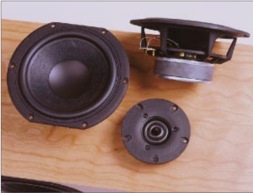
Die Tempo-Bestückung ist gut gewählt: Peerless-Tiefmitteltöner und ein neuartiger Ringstrahler von Vifa (links). Der Luna-Subwoofer lässt sich präzise auf die Raumgegebenheiten anpassen (unten).
