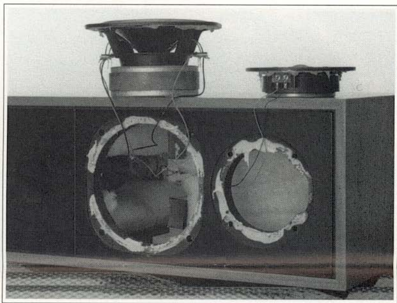
Die beiden hochkarätigen Treibereinheiten sind auf einer ungewöhnlich dicken Schallwand montiert
