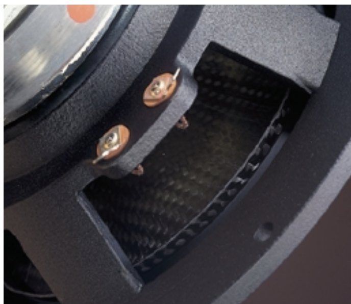
Der gefaltete Rand stabilisiert und versteift die sehr leichte Carbon-Fiber-Membran der Tieftonchassis zusätzlich
