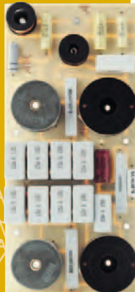
Die Frequenzweiche ist mit Bauteilen höchster Güte bestückt.
